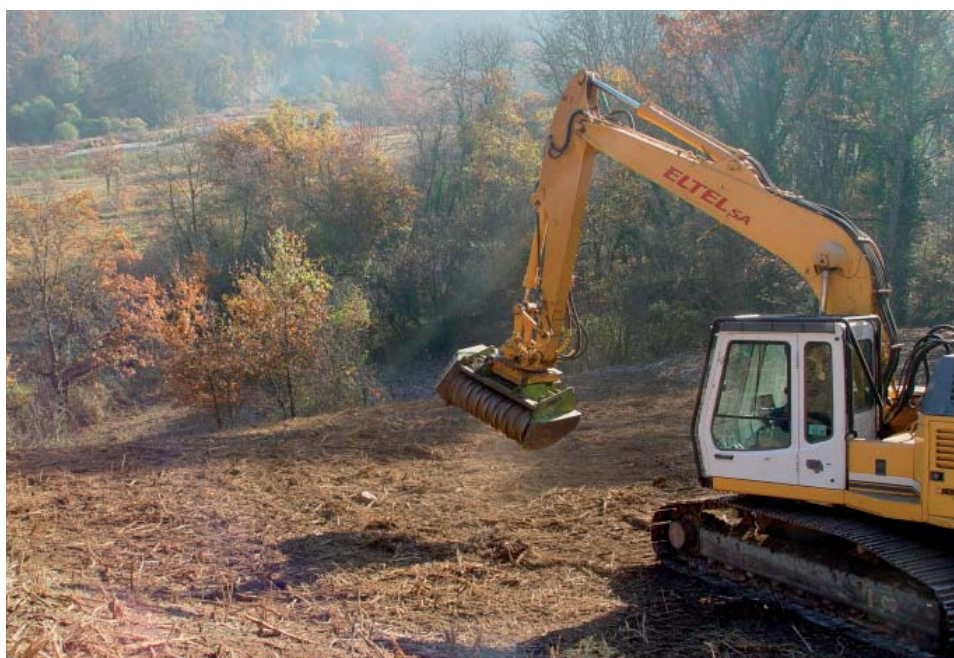
Fig 1: Débroussaillage du pâturage «les Ouches» avec la broyeuse brevetée par l'entreprise ELTEL (Y. Bourguignon, SCNP).
