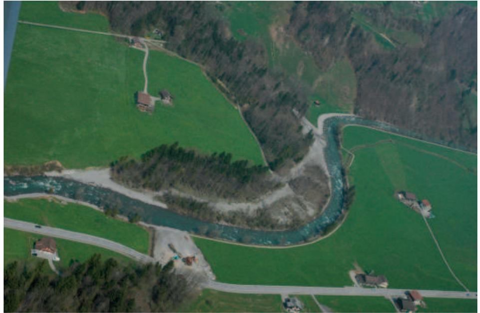
Blockrampe gesichert. Damit wird vermieden, dass es bei einem weiteren Hochwasserereignis flussaufwärts in Richtung Dorf Muotathal zu Auflandungen kommt. Solche Auflandungen könnten Rückstauungen zur Folge haben, was zu Überflutungen im Dorfbereich führen könnte. Parallel zur Kurvensicherung wurden die Schächte der Kanalisationsleitung und der freigespülte Strommasten mit Blocksteinen gesichert.
