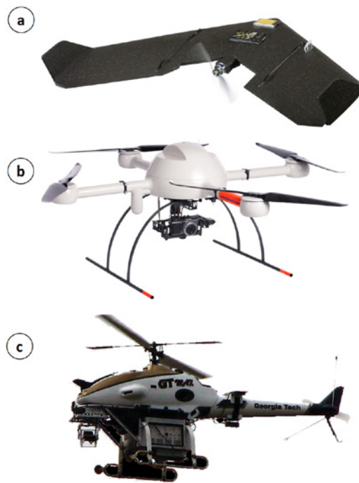
Abb. 1: Die Gruppe der unbemannten Luftfahrzeuge (unmanned aerial vehicle - UAV): Starrflügler (a) sind besonders für längere Flugzeiten und zur Erfassung grösserer Flächen geeignet. Im Gegensatz dazu erlauben Rotorflügler flexible Flugmanöver auch im Nahbereich zu erfassender Objekte und werden in Ein- (c), Doppel-, Vier- (b), Acht- oder Multirotor-systeme untergliedert (Van Blyenburg 1999, Photo credits: a) www.sensefly.com , b) www.microdrones.com , c) rmax.yamaha-motor.com.au ).
