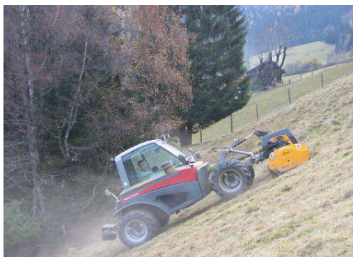
Bild 24: Mulchen mit Zweifachsmäher (Bild: MR Aichfeld Leoben)
