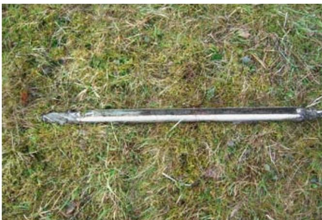
Abb. 3 Bohrer (Modell Hiller), mit Mergel und Torf gefüllte Probenkammer
