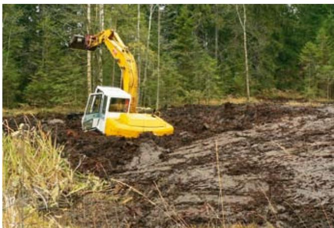
Abb. 31 Im Torf eingesunkener Kleinbagger
