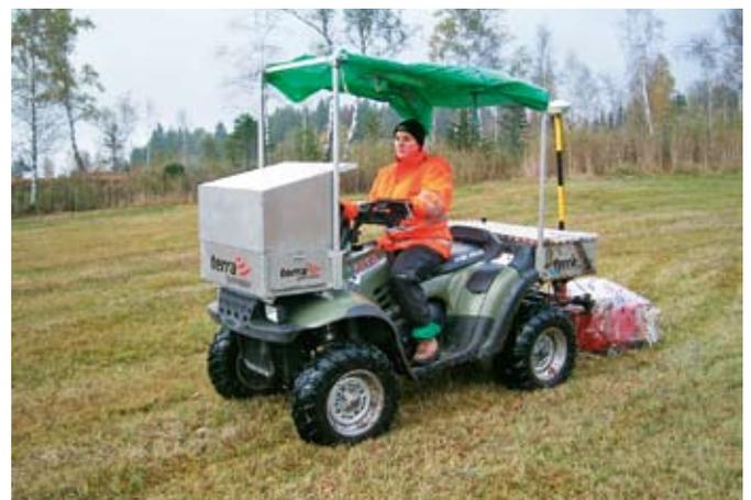
Abb. 4 Auf einem Quad montiertes Georadargerät
