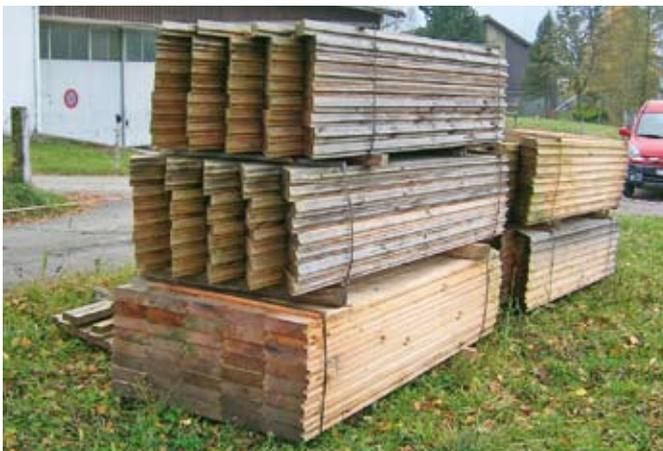
Abb. 98 Einseitig in einem spitzen Winkel abgesägte Bretter
