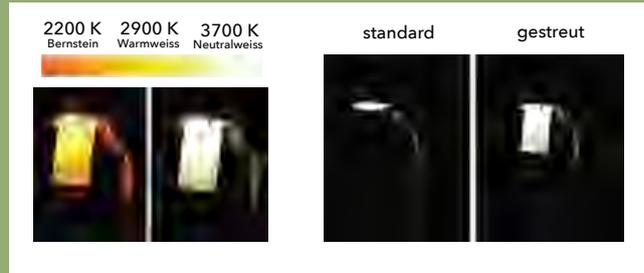
Die LED-Lichtbehandlungen. Zwei Dimmlevel (gedimmt um 50%, nicht gedimmt; keine Abbildung, zwei Leuchtenformen (rechts), sowie drei Lichtfarben (links) wurden untersucht.
